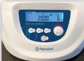
PRP 2000 rpm/6 min., für **Liquid Plasma Concentrate**
